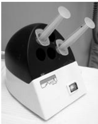
Gambar 1 Pemanas spuit The Vista untuk memanaskan spuit yang berisi NaOCl 5ml.
